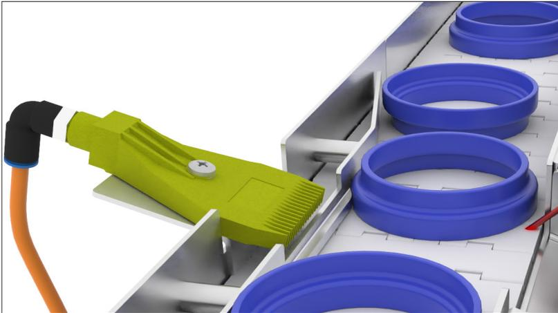
Der 1 mm kleine, sichtbare rote Laserpunkt ist auf das weiße Förderband gerichtet, das beim Teachen im Vordergrundaussblendungs-Modus eingelernt wurde. Liegt ein Bauteil kopfüber mit der Seite mit dem größeren Durchmesser auf dem Band und verhindert damit, dass der Sensor das Band sieht, befördert die Abblasdüse das Teil zurück in den Förderer.
