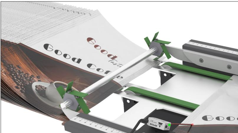
Die 1 mm kleinen runden Laserpunkte sind einfach auszurichten, so dass die Führungen richtig eingestellt werden können.
